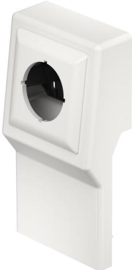
Geräteträger leer für den Sockelleistenkanal zum Einbau von Standardgeräten in Tragring- und Tragbügelbauweise mit 60-mm-Befestigungsspur.
