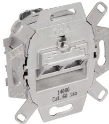
UAE Cat. 6 A ISO 8/8 Anschlussdose mit abbrechbarem Tragring für Stegversion. 2 Anschlüsse. Erfüllt die höchsten übertragungstechnischen Produktanforderungen gemäß ISO/IEC 11 801:2011-06 für 500 MHz Bandbreite (10 Gbit/s). Zentralplatte nicht im Lieferumfang enthalten, muss separat bestellt werden.
