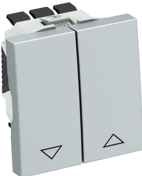
Rollladentaster mit elektrischer Verriegelung, 1-polig, 10 A, 250 V~, mit Steckklemmen.
