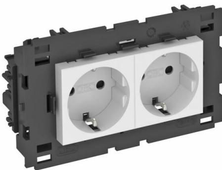
Schutzkontakt-Steckdose mit seitlichem Anschluss 2-fach 0°, mit erhöhtem Be- rührungsschutz, mit Steckklemmen, 2-polig, 16 A, 250 V~, mit Verbindungs- klemmen nach IEC 60884-1, geeignet für den Einbau in Geräteeinbau-Kanalsysteme Rapid 80.
