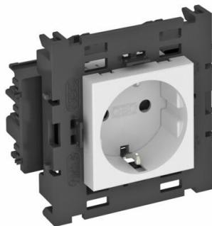
Schutzkontakt-Steckdose mit seitlichem Anschluss 1-fach 0°, mit erhöhtem Be- rührungsschutz, mit Steckklemmen, 2-polig, 16 A, 250 V~, mit Verbindungs klemmen nach IEC 60884-1, geeignet für den Einbau in Geräteeinbau-Kanalsysteme Rapid 80. Zur Installation in Rapid 45 Kanälen, Geräteeinbaukanälen, Installationssäulen, Unterflur-Systemen und Deskboxen.
