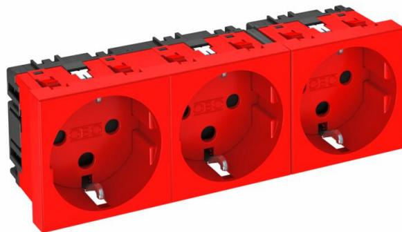
Schutzkontakt-Steckdose 3-fach 0°, kodierte Ausführung, mit erhöhtem Berührungsschutz, mit Steckklemmen, 2-polig, 16 A, 250 V~, mit Verbindungsstellen nach IEC 60884-1.
