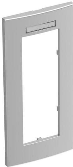
Frontlastender Abdeckrahmen für Modul 45 Einbaugeräte, 3fach, mit Beschriftungsfeld für senkrechte Geräteinstallation, zum Rasten in Geräteeinbaudose 71GD9-2 oder in Montageträger 71MT3 45-2.
