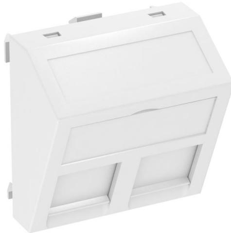
Datentechnikträger mit schrägem Auslass und Verschlusschieber zur Aufnahme von zwei Datentechnik-Anschlussmodulen mit RJ45-Buchse. Die Rastbefestigung eignet sich für den waagerechten und senkrechten Einbau in die Systemumgebung. Typ PA hat eine spezielle Modulaufnahme und ist für eine indirekte Befestigung der Daten-Anschlussmodule in der Montageöffnung ausgelegt. Datentechnikträger Typ PA ist für die Aufnahme der nachfolgenden Daten-Anschlussmodule geeignet: Panduit: Mini-Com.
