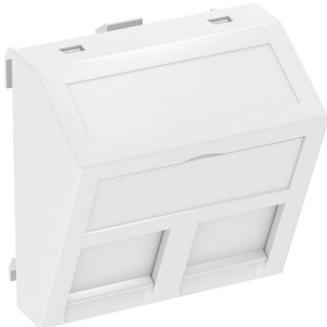
Datentechnikträger mit schrägem Auslass und Verschlusschieber zur Aufnahme von zwei Datentechnik-Anschlussmodulen mit RJ45-Buchse. Die Rastbefestigung eignet sich für den waagerechten und senkrechten Einbau in die Systemumgebung. Typ C hat eine Montageöffnung von 19,30 X 14,80 mm und ist für die direkte Befestigung der Daten-Anschlussmodule in der Montageöffnung ausgelegt.
