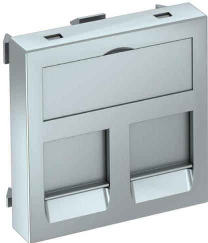
Datentechnikträger mit geradem Auslass und Verschlusschieber zur Aufnahme von zwei Datentechnik-Anschlussmodulen mit RJ45-Buchse. Die Rastbefestigung eignet sich für den waagerechten und senkrechten Einbau in die Systemumgebung. Typ PA hat eine spezielle Modulaufnahme und ist für eine indirekte Befestigung der Daten-Anschlussmodule in der Montageöffnung ausgelegt. Datentechnikträger Typ PA ist für die Aufnahme der nachfolgenden Daten-Anschlussmodule geeignet: Panduit: Mini-Com.
