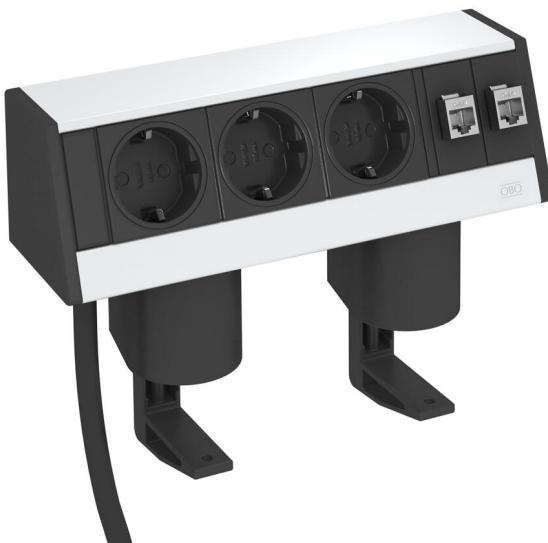
Deskbox mit Anschlusskabel, Kabelauslass von unten aus dem Profil, mit zwei Befestigungszwingen für Tischplattenstärken von 8 bis 40 mm. Bestückung: - drei schwarze Schutzkontakt-Steckdosen in 0°-Steckrichtung, inkl. 3,0 m Netzkabel mit Winkelstecker CEE 7/7. - zwei Datentechnik-Kupplungen RJ45 auf RJ45, 1:1 verschaltet, Kat.6 geschirmt.
