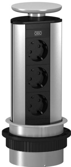
Versenkbare Deskbox mit Anschlusskabel, für den festen Einbau in eine Tischplatte, Befestigungsmanschette aus Kunststoff, passend lackiert in Deckelfarbaton. Die Montage erfolgt über eine Bohrung ( $\varnothing 102$  mm) in der Tischplatte. Bestückung: - drei schwarze Schutzkontakt-Steckdosen in 60°-Steckrichtung, inkl. 3,0 m Netzkabel mit Winkelstecker CEE 7/7. Hinweis: Einsetzbar in Tischplatten bis maximal 50 mm Stärke.
