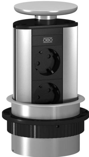
Versenkbare Deskbox mit Anschlusskabel, für den festen Einbau in eine Tischplatte, Befestigungsmanschette aus Kunststoff, passend lackiert in Deckelfarbaton. Die Montage erfolgt über eine Bohrung (Ø102 mm) in der Tischplatte. Bestückung: - zwei schwarze Schutzkontakt-Steckdosen in 60°-Steckrichtung, inkl. 3,0 m Netzkabel mit Winkelstecker CEE 7/7. Hinweis: Einsetzbar in Tischplatten bis maximal 50 mm Stärke.
