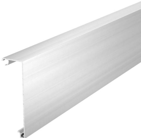
Kanalabdeckung zur Erstellung eines Design-Geräteeinbaukanals der Serie GAD. Designausführung "Style" zur vollständigen Abdeckung der Systemöffnung und der Schalt- und Steckgeräte. Die Oberteiladapter GAD OTA sind zwingend erforderlich und sollten im max. Abstand von 50 cm auf der Kanalstrecke eingeplant werden. Zwischen den Kanalabdeckungen muss ein Distanzstück GAD OTD gesetzt werden.
