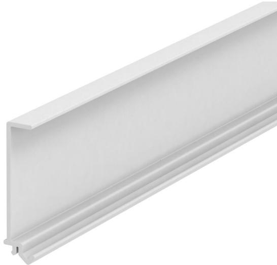
Trennwand aus halogenfreiem PC/ABS zur Montage in Rapid 80 GKH (GA) Geräteeinbaukanälen oder ISS Installationssäulen für die Installation von Kabeln und Leitungen unterschiedlicher Spannungsebenen.
