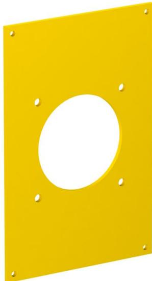
Abdeckplatte mit einer Ø 70-mm-Öffnung zum Einbau von 1 x CEE-Steckdose 16/32 A mit 60-mm-Befestigungsspur, inklusiv 4 Schrauben zur Gerätebefestigung.
