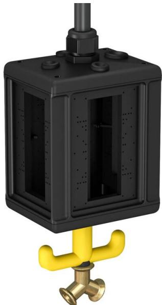
Leergehäuse mit 1 m Rohr 1/2" und Anschluss für Druckluftschlauch 13 x 3,5 mm und 2-Wege-Verteiler 1/2". Mit Aufhängeöse und Griffhaken, zum Einbau von elektrischen Betriebsmitteln, mit beigelegter Trennwand. Ohne Abdeckplatten. Zur Versorgung von Arbeitsplätzen in nassen Bereichen. Schutzgrad: IP 44.
