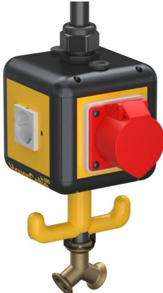
Gehäuse bestückt und vorverdrahtet, mit 1 m Rohr 1/2" und Anschluss für Druckluftschlauch 13 x 3,5 mm und 2-Wege-Verteiler 1/2", mit Aufhängeöse, Griffhaken und 4 Abdeckplatten.
