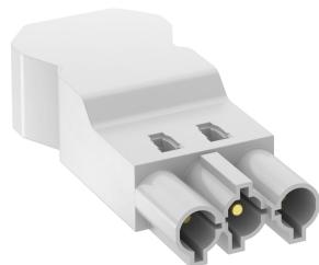
Steckerteil 3-polig, Typ GST18i mit Schraubanschluss für Leitungen 1,5 - 4,0 mm<sup>2</sup> und Leitungsdurchmesser von 10,5 - 14,5 mm (H05VV, NYM), unmontiert mit Zugentlastung, vor Ort konfektionierbar, 250 V, 16 A.
