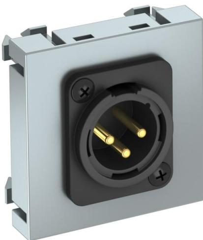
Multimediaträger mit einer XLR-Anschlussbuchse, Kabelauslass gerade, ohne Beschriftungsfeld, XLR-Stecker 3-polig mit Schraubanschluss. Trägerplatte mit Rastbefestigung, geeignet für den waagerechten und senkrechten Einbau in die Systemumgebung.
