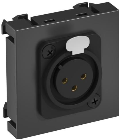
Multimediaträger mit einer XLR-Anschlussbuchse, Kabelauslass gerade, ohne Beschriftungsfeld, XLR-Buchse 3-polig mit Schraubanschluss. Trägerplatte mit Rastbefestigung, geeignet für den waagerechten und senkrechten Einbau in die Systemumgebung.
