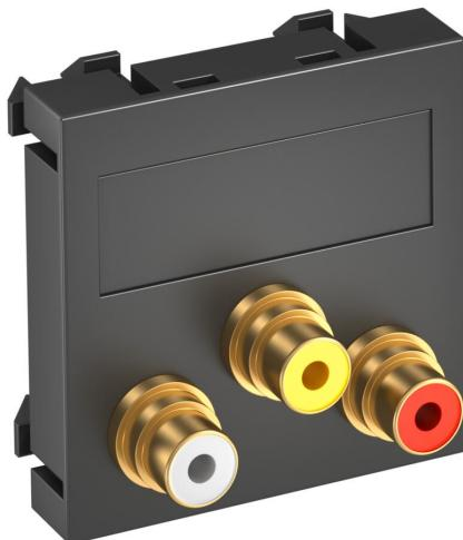
Multimediaträger mit drei Cinch-Anschlussbuchsen für Audio-Video, Kabelauslass gerade, mit Beschriftungsfeld, drei Cinch-Kupplungen (RCA) in Ausführung Buchse-Buchse, Farbkodierung gelb/rot/weiß. Trägerplatte mit Rastbefestigung, geeignet für den waagerechten und senkrechten Einbau in die Systemumgebung.
