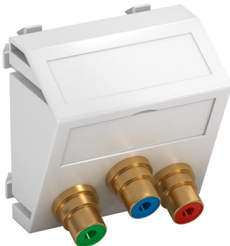
Multimediaträger mit drei Cinch-Anschlussbuchsen für Component Video, Kabelauslass schräg, mit Beschriftungsfeld, drei Cinch-Kupplungen (RCA) in Ausführung Buchse-Buchse, Farbkodierung rot/grün/-blau. Trägerplatte mit Rastbefestigung, geeignet für den waagerechten und senkrechten Einbau in die Systemumgebung.
