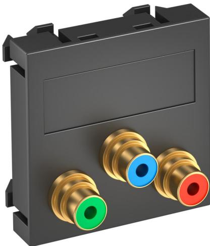
Multimediaträger mit drei Cinch-Anschlussbuchsen für Component Video, Kabelauslass gerade, mit Beschriftungsfeld, drei Cinch-Kupplungen (RCA) in Ausführung Buchse-Buchse, Farbkodierung rot/grün/blau. Trägerplatte mit Rastbefestigung, geeignet für den waagerechten und senkrechten Einbau in die Systemumgebung.
