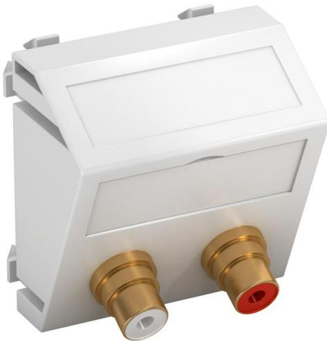
Multimediaträger mit zwei Cinch-Anschlussbuchsen für Audio R/L, Kabelauslass schräg, mit Beschriftungsfeld, zwei Cinch-Kupplungen (RCA) in Ausführung Buchse-Buchse, Farbkodierung rot/weiß. Trägerplatte mit Rastbefestigung, geeignet für den waagerechten und senkrechten Einbau in die Systemumgebung.
