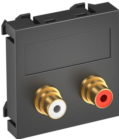
Multimediaträger mit zwei Cinch-Anschlussbuchsen für Audio R/L, Kabelauslass gerade, mit Beschriftungsfeld, zwei Cinch-Kupplungen (RCA) in Ausführung Buchse-Buchse, Farbkodierung rot/weiß. Trägerplatte mit Rastbefestigung, geeignet für den waagerechten und senkrechten Einbau in die Systemumgebung.
