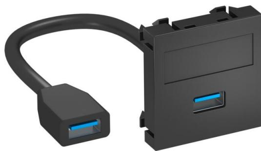
Multimediaträger mit einer USB 3.0-Anschlussbuchse, Kabelauslass gerade, mit Beschriftungsfeld, kurzes USB 3.0 Typ A-Anschlusskabel in Ausführung Buchse-Buchse-Buchse. Trägerplatte mit Rastbefestigung, geeignet für den waagerechten und senkrechten Einbau in die Systemumgebung.
