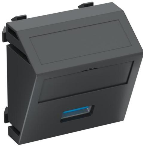
Multimediaträger mit einer USB 3.0-Anschlussbuchse, Kabelausslass schräg, mit Beschriftungsfeld, USB 3.0-Buchse Typ A mit Schraubanschluss. Trägerplatte mit Rastbefestigung, geeignet für den waagerechten und senkrechten Einbau in die Systemumgebung.
