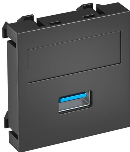
Multimediaträger mit einer USB 3.0-Anschlussbuchse, Kabelausslass gerade, mit Beschriftungsfeld, USB 3.0-Buchse Typ A mit Schraubanschluss. Trägerplatte mit Rastbefestigung, geeignet für den waagerechten und senkrechten Einbau in die Systemumgebung.
