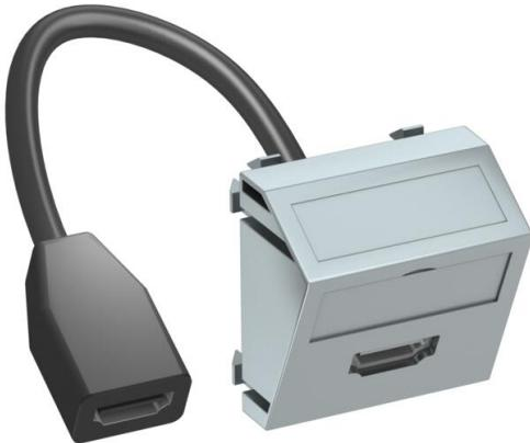
Multimediaträger mit einer HDMI Anschlussbuchse, Kabelausslass schräg, mit Beschriftungsfeld, kurzes HDMI Anschlusskabel in Ausführung Buchse-Buchse. Trägerplatte mit Rastbefestigung, geeignet für den waagerechten und senkrechten Einbau in die Systemumgebung.
