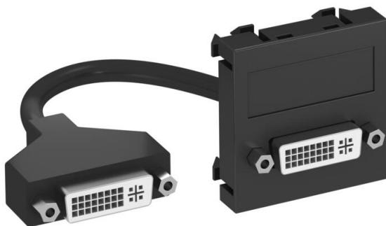
Multimediaträger mit einer DVI-I Anschlussbuchse, Kabelauslass gerade, mit Beschriftungsfeld, kurzes DVI-I Anschlusskabel in Ausführung Buchse-Buchse. Träger mit Rastbefestigung, geeignet für den waagerechten und senkrechten Einbau in die Systemumgebung.
