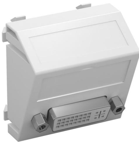
Multimediaträger mit einer DVI-D-Anschlussbuchse, Kabelausslass schräg, mit Beschriftungsfeld, DVI-D-Buchse mit Schraubanschluss. Trägerplatte mit Rastbefestigung, geeignet für den waagerechten und senkrechten Einbau in die Systemumgebung.
