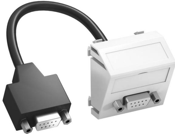
Multimediaträger mit einer D-Sub9-Anschlussbuchse, Kabelausslass schräg, mit Beschriftungsfeld, kurzes D-Sub9-Anschlusskabel (RS232) in Ausführung Buchse-Buchse. Träger mit Rastbefestigung, geeignet für den waagerechten und senkrechten Einbau in die Systemumgebung.
