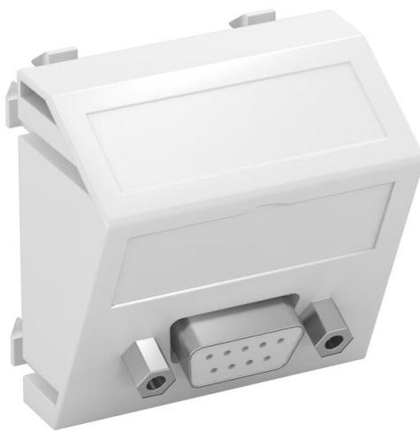
Multimediaträger mit einer D-Sub9-Anschlussbuchse, Kabelausslass schräg, mit Beschriftungsfeld, D-Sub9-Buchse (RS232) mit Schraubanschluss. Trägerplatte mit Rastbefestigung, geeignet für den waagerechten und senkrechten Einbau in die Systemumgebung.
