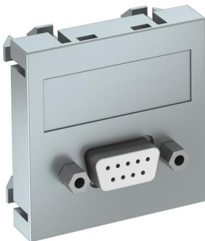
Multimediaträger mit einer D-Sub9-Anschlussbuchse, Kabelauslass gerade, mit Beschriftungsfeld, D-Sub9-Buchse (RS232) mit Schraubanschluss. Trägerplatte mit Rastbefestigung, geeignet für den waagerechten und senkrechten Einbau in die Systemumgebung.
