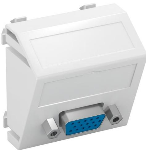
Multimediaträger mit einer VGA-Anschlussbuchse, Kabelauslass schräg, mit Beschriftungsfeld, VGA-Buchse (HD15) mit Schraubanschluss. Trägerplatte mit Rastbefestigung, geeignet für den waagerechten und senkrechten Einbau in die Systemumgebung.
