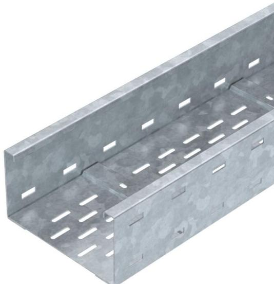
Weitspannkabelrinnen-System, gelocht, mit der Seitenhöhe 110 mm. Längsverbinder Typ WRVL 110 sind anteilig separat zu bestellen. Magnetische Schirmdämpfung ohne Deckel 20 dB, mit Deckel 50 dB.
