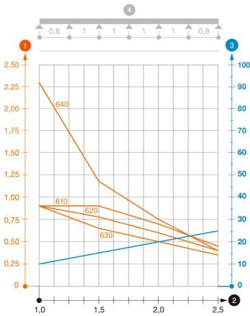
Belastungsdiagramm Kabelrinne Typ IKS 60
