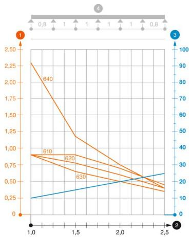
Belastungsdiagramm Kabelrinne Typ IKS 60
