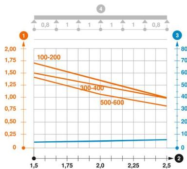
Belastungsdiagramm Kabelrinne Typ MKSM 85
