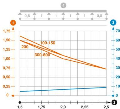
**Belastungsdiagramm Kabelrinne Typ MKSM 60**
