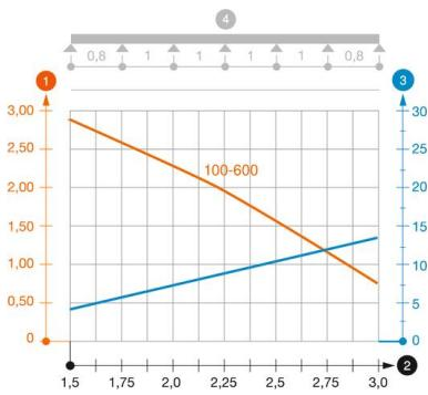
Belastungsdiagramm Kabelrinne Typ SKS 85
