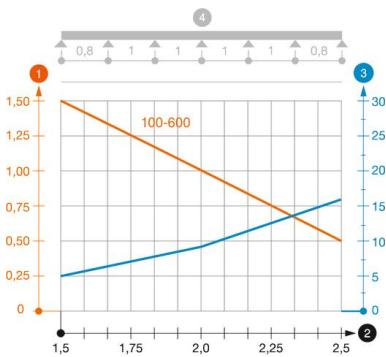
Belastungsdiagramm Kabelrinne Typ MKS 60 VA
