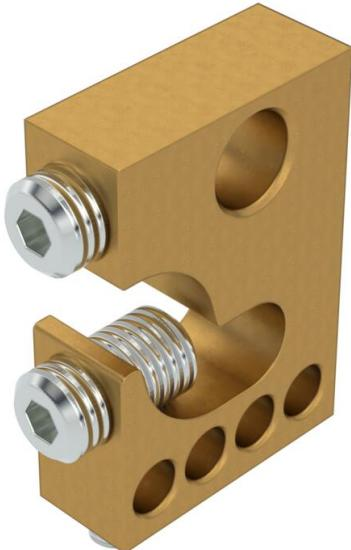
Zweifache Anschlussklemme zur Aufnahme von 2 Leiterseilen, zum Erstellen des Schutzzentialausgleichs bei Kabeltragsystemen. Zur Direktmontage an Kabeltragsystemen mit Schraube M8 geeignet. Leiterseil bis max. 120 mm<sup>2</sup>, 4 Erdungskabelanschlüsse mit max. 35 mm<sup>2</sup> nach DIN 46228 Teil 4, Abisolierlänge 18 mm.
