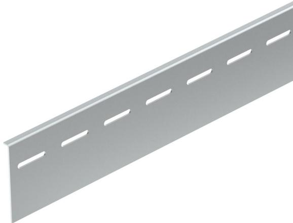
Schutzblech, zur seitlichen Anbringung als Trittschutz für begehbarer Kabelrinnensystem. Das Schutzblech kann mittels Linsen-Blechschräuben Typ SPHS an den Z-Stützen installiert werden.
