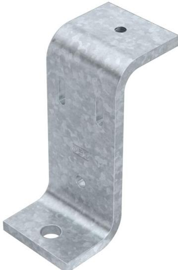
Z-Stütze zur Aufständerung des begehbarer Kabelrinnensystems BKRS am Boden. Befestigung der Kabelrinne an der Z-Stütze mit Flachkopfschraube FKS 6 x 12 mm (Art.-Nr. 6049246) in M6-Gewindeloch.
