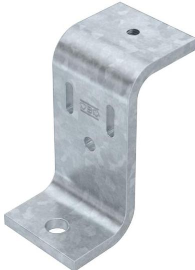
Z-Stütze zur Aufständerung des begehbarer Kabelrinnensystems BKRS am Boden. Befestigung der Kabelrinne an der Z-Stütze mit Flachkopfschraube FKS 6 x 12 mm (Art.-Nr. 6049246) in M6-Gewindeloch.
