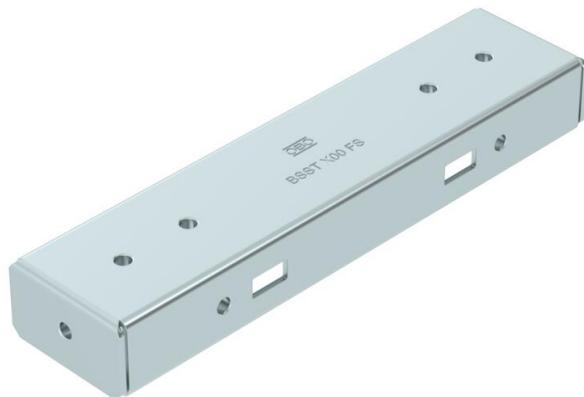
Traverse der symmetrischen Bodenstütze für das BKRS-System, passend für Unterteil Typ BSSU 190 2030. Einsetzbar für begehbarer Kabelrinnen Breite 200 mm. Mit Gewindedurchzügen zum spanlosen Montieren von Kabelrinnen. Befestigung an Unterteil mit 4x FKS Flachkopfschraube M6. Befestigungsmaterial muss separat bestellt werden.
