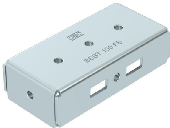
Traverse der symmetrischen Bodenstütze für das BKRS-System, passend für Unterteil Typ BSSU 190 1010. Einsetzbar für begehbarer Kabelrinnen Breite 100 mm. Mit Gewindedurchzügen zum spanlosen Montieren von Kabelrinnen. Befestigung an Unterteil mit 4x FKS Flachkopfschraube M6. Befestigungsmaterial muss separat bestellt werden.
