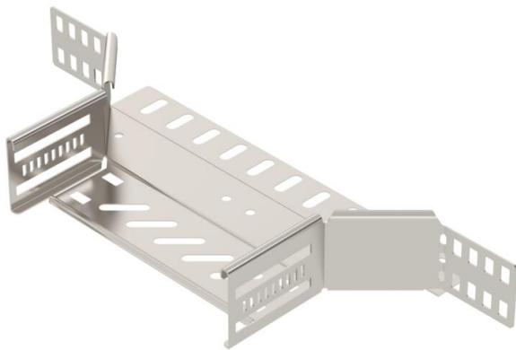
Anbau-Abzweigstück zum Erstellen einer horizontalen Abzweigung oder Kreuzung, Formteil für rast- und schraubbare Kabelrinnen Seitenhöhe 60 mm. Schraubenlose Montage mit Doppelklemmen oder Schraubverbindung mit Flachrundschaften FRS und Kombimuttern M6. Einsetzbar im Innen- und Außenbereich. Befestigungsmaterial muss separat bestellt werden.
